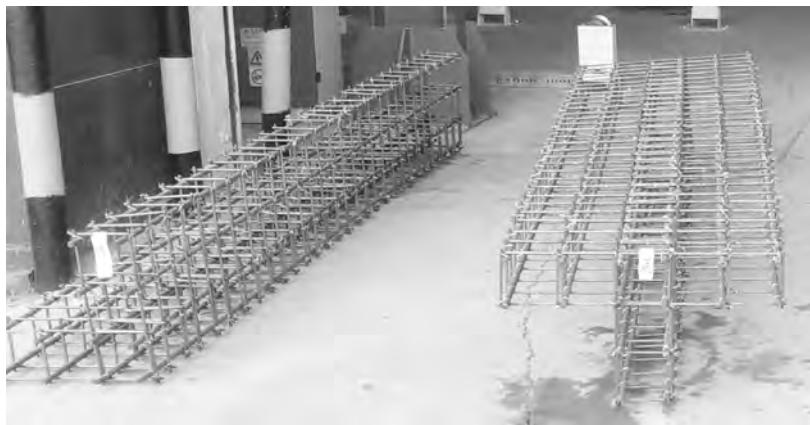
图 2-14 工厂生产的成型钢筋笼
