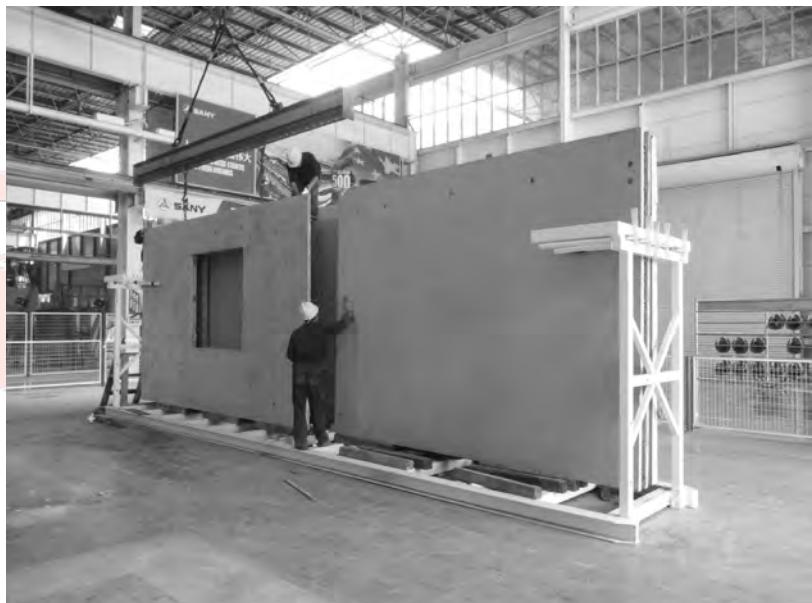
图 2-12 叠合墙构件下线
