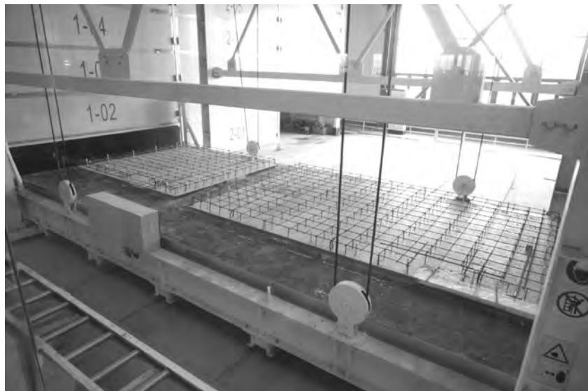
图 2-9 构件入窑养护
