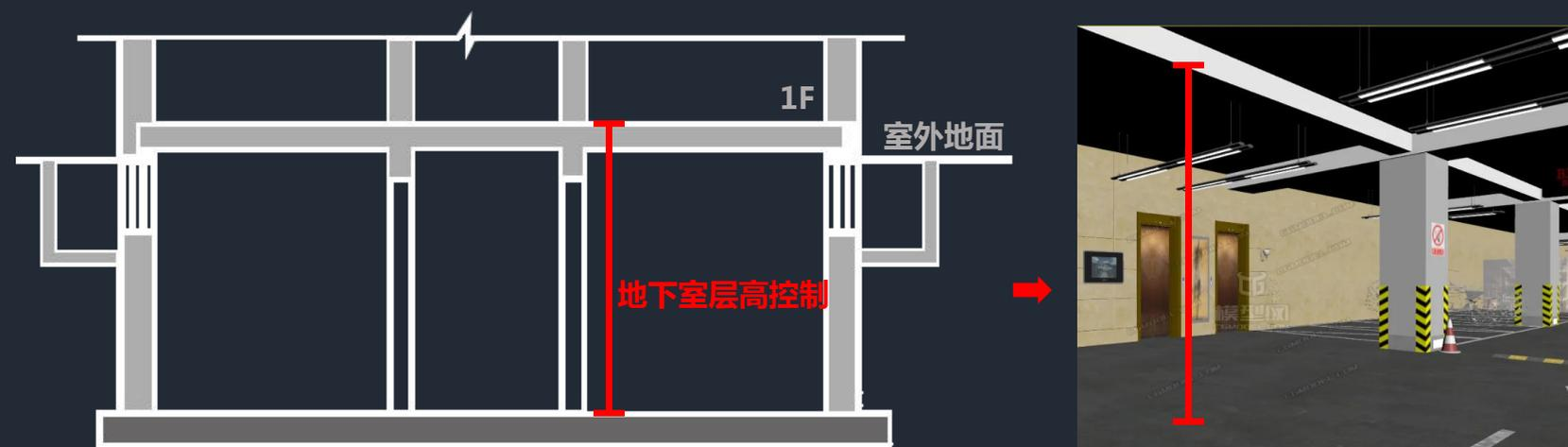
图示1 层高控制示意
