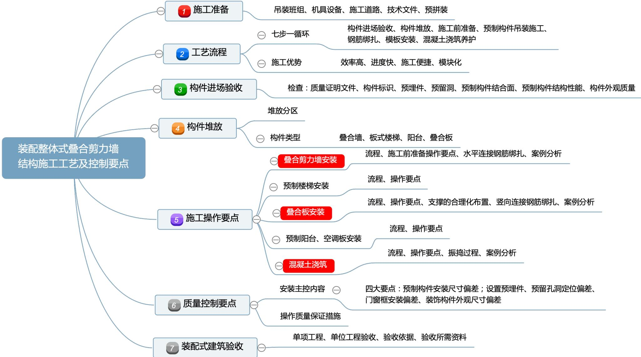
装配式整体式叠合剪力墙结构施工工艺及控制要点
