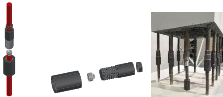
图 9 金砼套筒安装示意图
