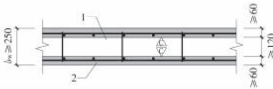
图 5.4.4a 叠合地下室外墙平面图
