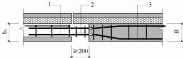
1—梁连接钢筋;2—现浇段附加箍筋;3—梁内纵筋; $b_w$ —叠合剪力墙宽度; $B$ —梁宽度
