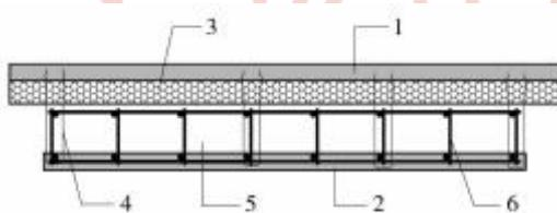
(b) 夹心保温空腔预制墙构件剖面图
