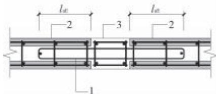
1—环状连接筋;2—叠合构件;3—后浇混凝土墙段;
