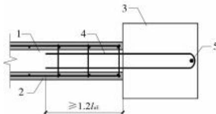
1—墙体现浇部分;2—预制部分;3—边框柱;4—U型搭接钢筋;5—柱纵筋
