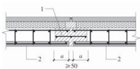
(e) 夹心保温叠合剪力墙一字型连接
