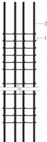
(b) 柱成型钢筋笼剖面图
