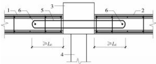
1—左侧剪力墙;2—右侧剪力墙;3—现浇扶壁柱;4—楼面梁;
