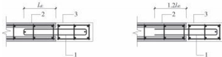
1—环状连接筋或 U型连接筋;2—叠合构件;3—后浇混凝土墙段
