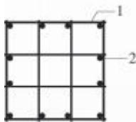
(a) 柱成型钢筋笼截面图
