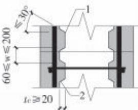
图 5.4.4b 叠合地下室外墙键槽构造示意
