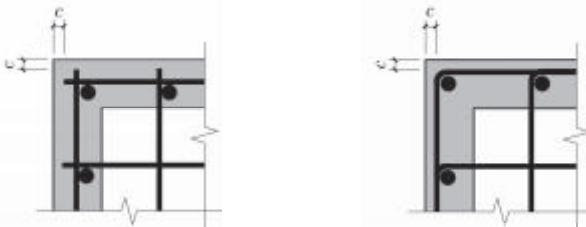
(a) 钢筋焊接网叠合构件保护层示意图 (b) 弯折成型焊接钢筋网叠合构件保护层示意图
