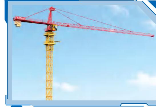
SPCS 空腔构件较灌浆套筒构件轻，塔吊型号降低，
