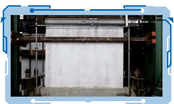
剪力墙结构构件实验
