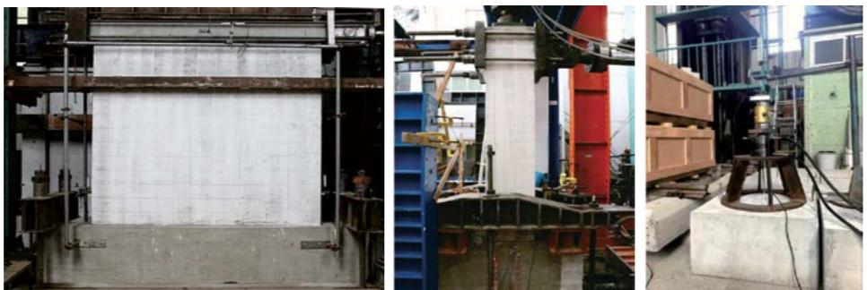
剪力墙结构构件实验
